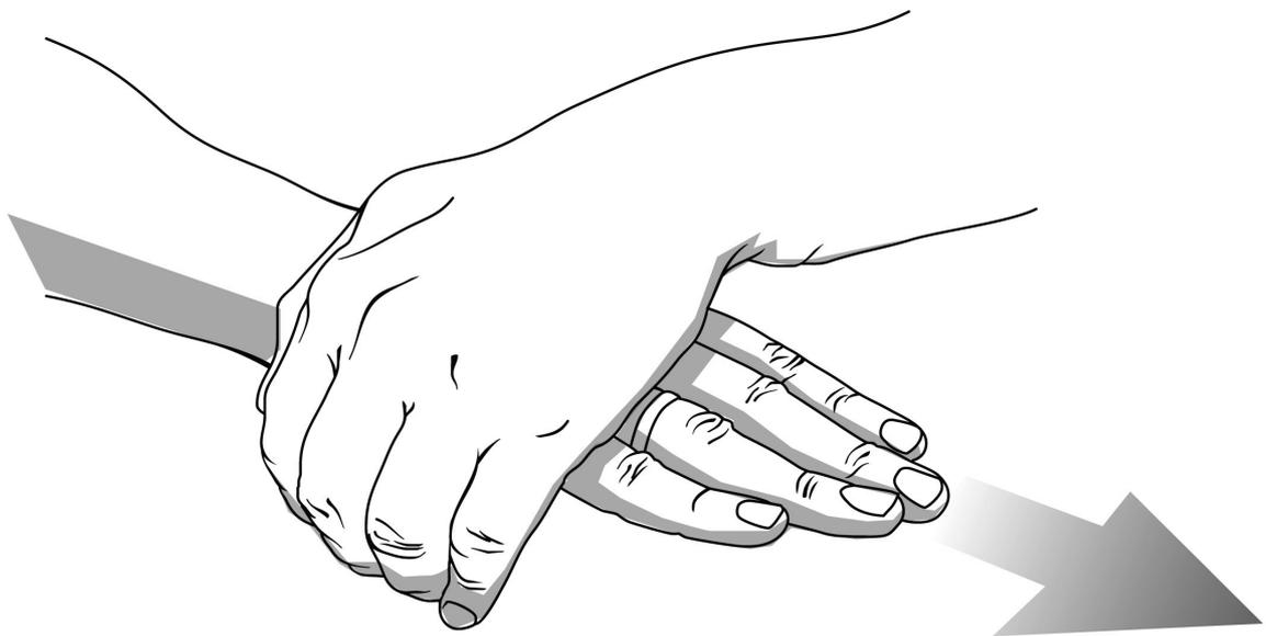
Die ausgestreckte flache rechte Hand (*elektrisches Feld*) geht vorwärts (*nimmt zu*), während sie die linke Hand (*Magnetfeld*) mit der Handfläche nach innen umfasst.
